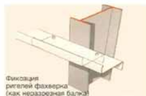
крепление к колонне (установка стеновых прогонов)
